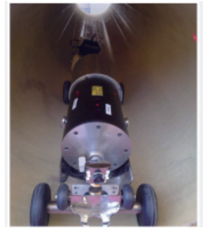
系统3 带WI-FI模块的多传感器内径测量系统
